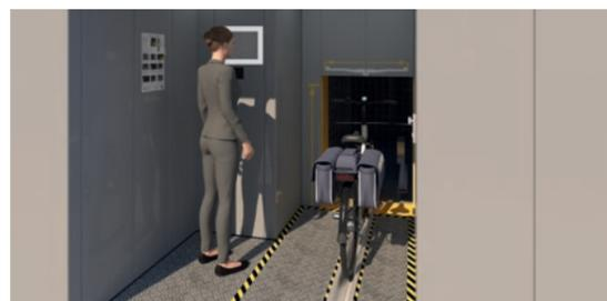
**6** Das Tor öffnet sich vollständig und Ihr Fahrrad wird eingezogen. Sobald das Schiebetor vollständig geschlossen ist, verlassen Sie den Übergabebereich.
