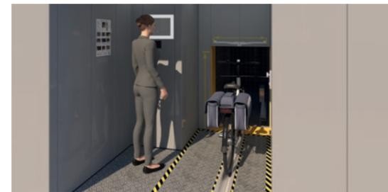
**2** Betreten Sie während des Auslagerungsvorgangs nicht die Trittmatte, sonst wird die Auslagerung unterbrochen.
