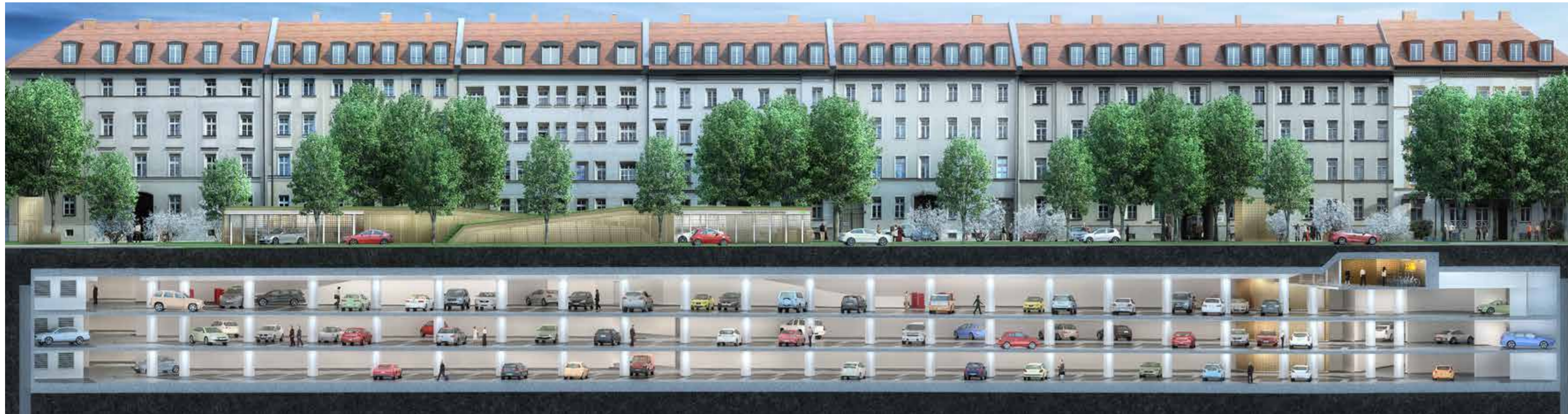
Aktuelles Projekt: Die Tiefgarage unter dem Thomas-Wimmer-Ring ist Teil des Projektduos „TOM und HILDE“. Auf einer Länge von 140 Metern und in einer Tiefe von 30 Metern entstehen hochmoderne und sehr komfortable Stellplätze. Grafiken: WÖHR + BAUER GmbH
