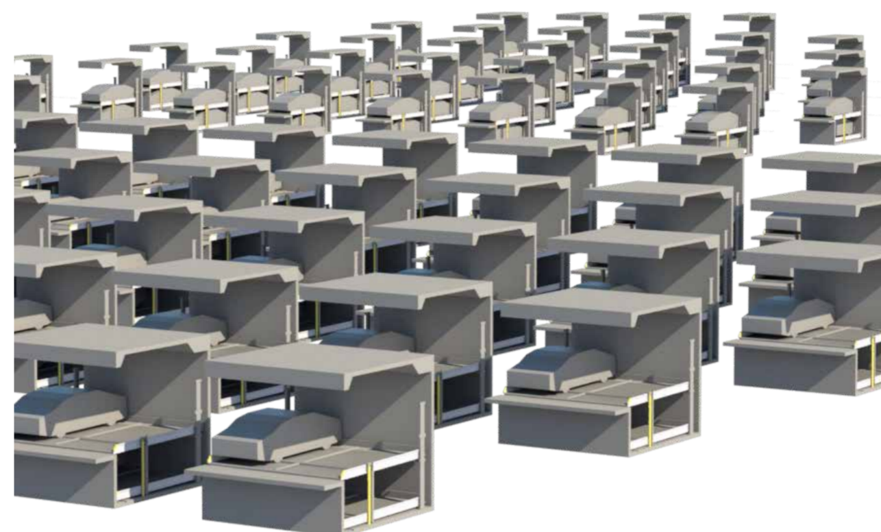
Solide Datengrundlage: Alle Typen eines Parklift-450-Modells werden in einer Datei geliefert (Höhen, Tiefen, Breiten und Fahrzeugbelastung).
