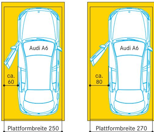
Je nach Fahrzeugmodell und Parkposition des Fahrzeugs auf der Plattform fällt der Platz zur Türöffnung unterschiedlich groß aus. Für komfortable Verhältnisse zum Ein- und Aussteigen empfehlen wir Plattformbreiten ab 270 cm.
