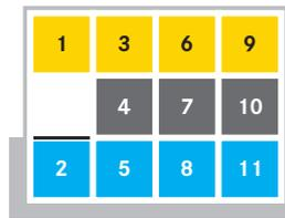
Über den Leerplatz kann bei MR-Anlagen in die hintere Anlage durchgefahren werden.
