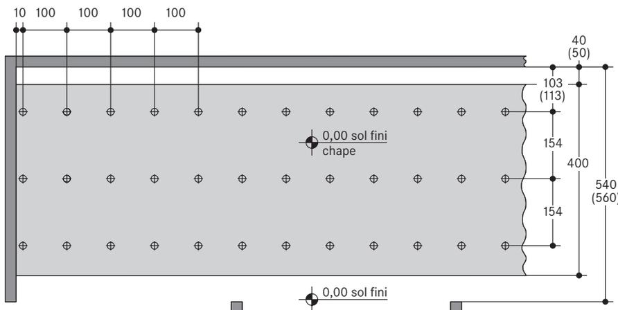
⊕ Points de mesure distants de 100 cm sur la longueur, destinés à vérifier les défauts de planéité selon la norme DIN 18202, tableau 3, ligne 3 ou selon le diagramme
