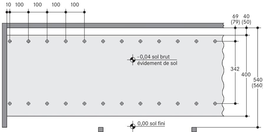
⊕ Points de mesure distants de 100 cm sur la longueur, destinés à vérifier les défauts de planéité selon la norme DIN 18202, tableau 3, ligne 2 ou selon le diagramme
