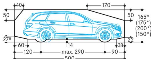
\* La hauteur totale de la voiture, y compris la galerie et le support de l'antenne, ne devra pas dépasser les cotes maximales de hauteur de voiture indiquées ici!
